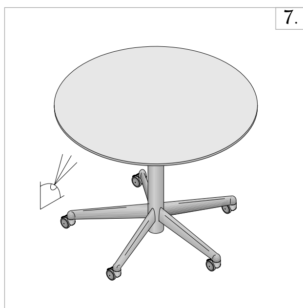
Le verrouillage se trouve sous le plateau.
