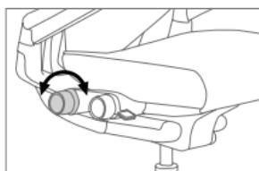
**Tensão da basculação –** Permite-lhe ajustar a força exigida para manter a costa da cadeira direita ou reclinada. Rode o manipulo para a frente e para trás para aumentar e diminuir a resistência exercida pela costa.
