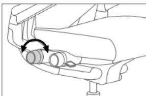
**Tensione spalliera** – Permette di regolare la forza richiesta per sedersi a schiena dritta o inclinata. Ruotare il pomello in avanti per aumentare la resistenza e indietro per diminuirla.
