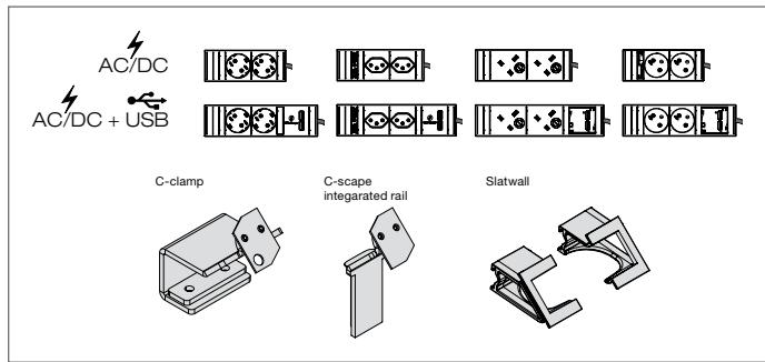
Verschiedene Befestigungsoptionen erhältlich: C-Klemme, Orga-Rail und integrierte Schiene
