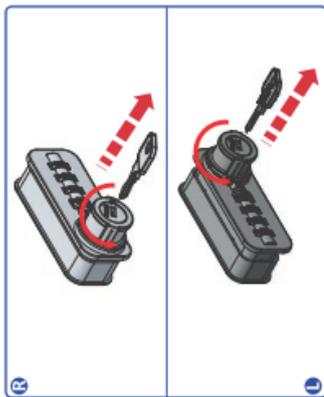
Drehknopf auf bestehender 20° Position (der Pfeil am Drehknopf steht mittig auf dem roten Dreieck am Schlosseingangsgehäuse) festhalten und NUR den Schlüssel gegen den Uhrzeigersinn 180° zurückdrehen und entnehmen.
